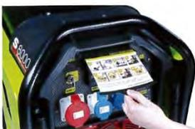
Im Bedienpanel integrierte, unverlierbare Kurzbetriebsanleitung
